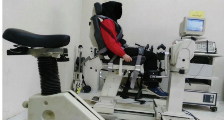
شکل ۲. وضعیت آزمودنی در اندازه‌گیری گشتاور اینترنال روتیشن و اکسترنال روتیشن
