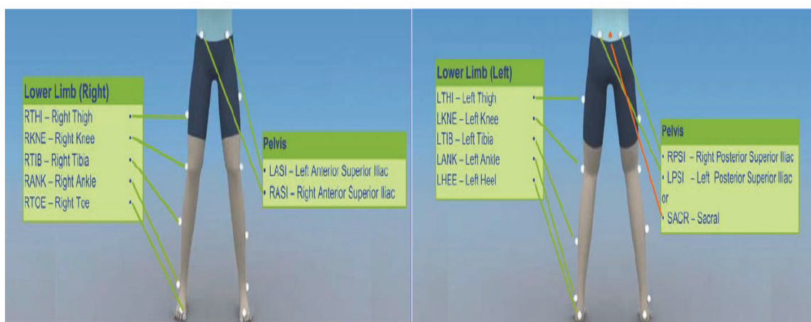
شکل ۱. قرارگیری مارکرها برای مدل پلاگین گیت اندام تحتانی (نمای جلویی، عقبی).
