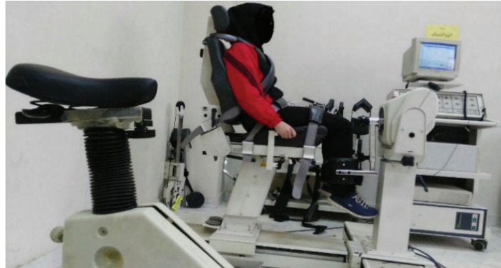
شکل ۲. وضعیت آزمودنی در اندازه‌گیری گشتاور اینترنال روتیشن و اکسترنال روتیشن
